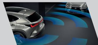
Sensores de estacionamento inteligente (Intelligent Clearance Sonar - ICS) - abaixo de 15 km/h
