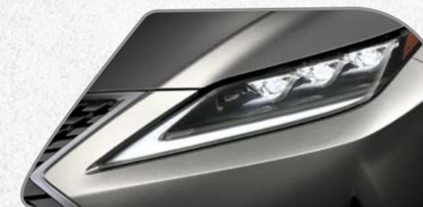
Faros de luces diurnas de posicionamiento de led en forma de L con bajo consumo de energía
