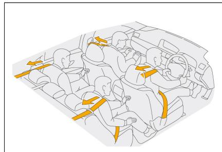
Um mecanismo do pré-tensionador é integrado ao retrator de cada um dos cintos de segurança dianteiros. Alguns modelos possuem pré-tensio-
