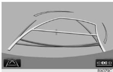
► Modo de exibição da linha-guia de assistência a estacionamento (→P.285)
