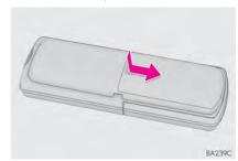
2 Remova as baterias esgotadas e instale novas baterias.
