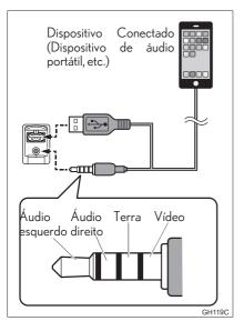
Ao reproduzir um vídeo de iPod, faz-se necessário o uso de um cabo auxiliar P2 de 4 polos e do conector de USB. Conecte os conectores às respectivas portas AUX e USB.
