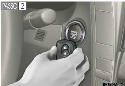
Toque no lado do emblema Lexus na chave eletrônica do interruptor do motor.
