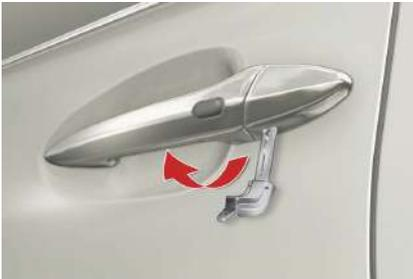
Remova a cobertura da maçaneta da porta do motorista usando a chave mecânica para executar as operações abaixo.
