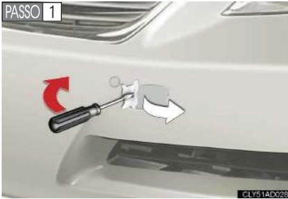
Remova a capa do olhal usando uma chave de fenda.
