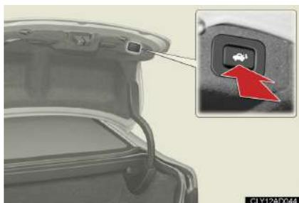
Pressionar o interruptor irá fechar a tampa do porta-malas automaticamente. (Um alarme irá soar).
