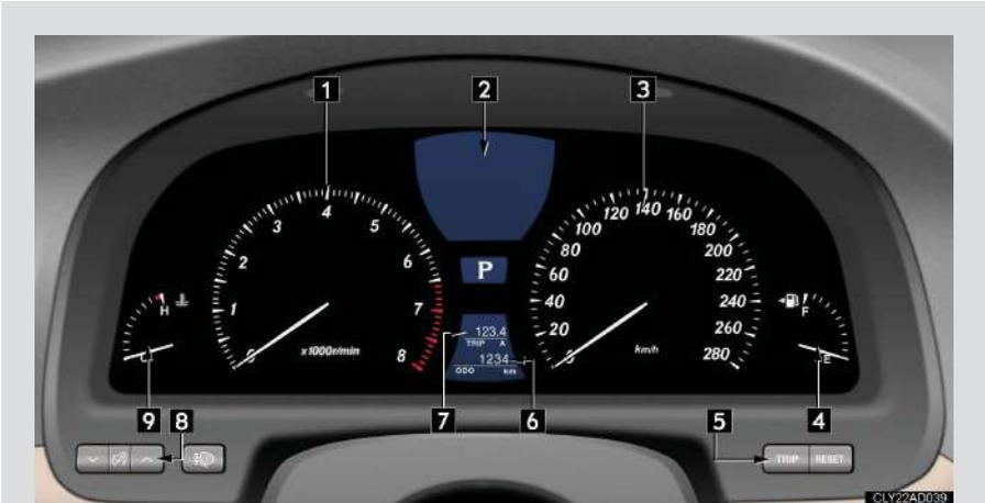
Os instrumentos e medidores abaixo e o mostrador irão acender quando o interruptor do motor estiver posicionado em IG-ON.
