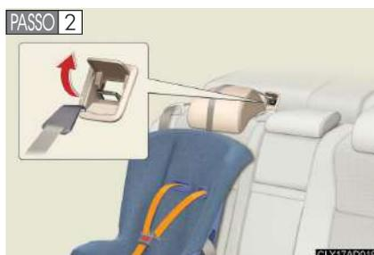
Abra a tampa do suporte de ancoragem, encaixe o gancho no suporte de ancoragem e aperte o cinto superior.
