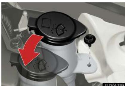
Remova o parafuso de fixação e mova a abertura de abastecimento de fluido do lavador.
