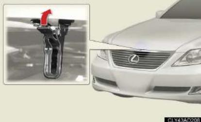
Levante o engate e o capô do motor.
