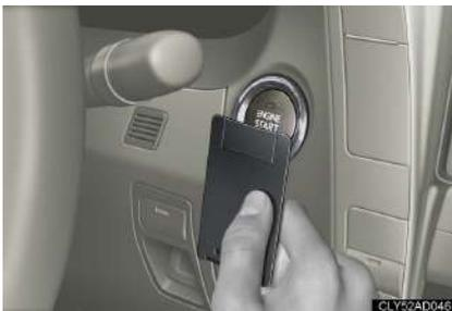
**PASSO 3** Pressione o interruptor do motor no período de 10 segundos (após o alarme soar), mantendo o pedal de freio pressionado.
