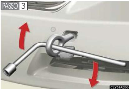
Aperte os olhais de rebocamento firmemente usando uma chave para porca de roda.
