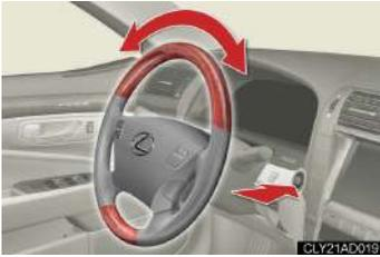
A luz indicadora verde no interruptor do motor irá piscar e uma mensagem será apresentada no mostrador multifunção. Pressione novamente o interruptor do motor, mova o volante de direção para a esquerda e para a direita.
