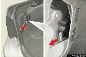
A alavanca apresentada na figura ao lado pode ser usada para abrir a portinhola se a abertura não for possível usando o interruptor interno devido à bateria descarregada ou qualquer outra razão.
