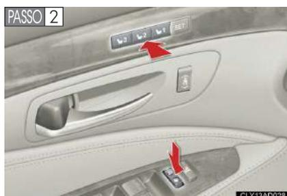
Pressionando a tecla desejada (1, 2 ou 3), pressione o lado de travamento ou destravamento no interruptor da fechadura da porta (no lado do motorista ou no lado do passageiro) até que o bip soe.
