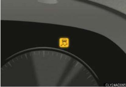
Se houver o risco de derrapagem, rolagem para trás durante a partida em um aclive, ou se as rodas traseiras patinarem, o indicador irá piscar para indicar que os sistemas VSC/TRC/control de assistência de partida em aclive foi acoplado.
