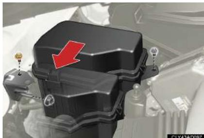
Remova os parafusos de fixação e a porca, e mova o bloco de fusíveis.
