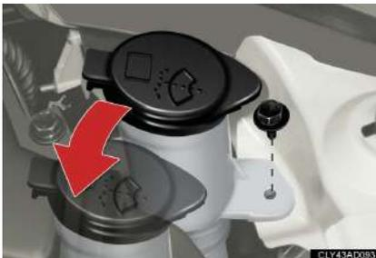
Remova o parafuso de fixação e mova a abertura de abastecimento de fluido do lavador.
