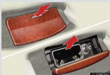
Pressione a parte dianteira da tampa para abrir. Pressione a tampa novamente para fechar.
