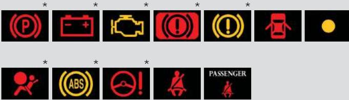
\*: Estas luzes irão acender quando o interruptor do motor for posicionado no modo IG-ON para indicar que a inspeção do sistema está sendo executada. As luzes irão apagar após a partida do motor, ou após alguns segundos. Poderá haver falha em um sistema se a luz não acender, ou se as luzes não apagarem. Providencie a inspeção do veículo em uma Concessionária Autorizada Toyota para veículos da marca Lexus.
