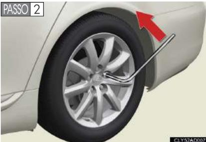
Solte levemente as porcas das rodas (uma volta).
