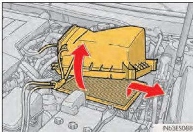
Inspeção a superfície externa do filtro, e substitua o filtro caso ele esteja extremamente sujo. Se o filtro estiver apenas moderadamente sujo, use ar comprimido para soprar a poeira do filtro.
