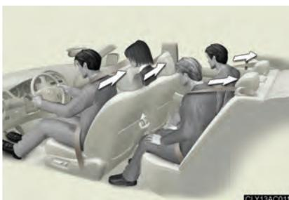
O pretensionador aumenta a proteção do ocupante ao retraindo rapidamente o cinto de segurança quando o veículo é submetido a determinados tipos de colisão frontal grave.
