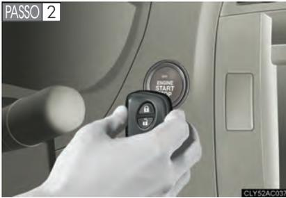
Toque o lado do emblema Lexus na chave eletrônica para o interruptor “ENGINE START STOP”.
