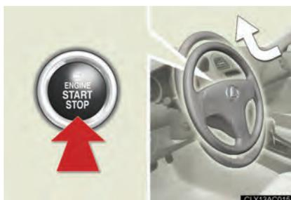
Quando o interruptor do motor for desligado, o volante de direção irá retornar à posição recolhida, movimentando-se para cima e afastando-se do motorista, facilitando a sua entrada ou saída do veículo.
