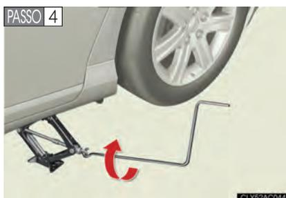
Levante o veículo até que o pneu esteja levemente levantado do piso.
