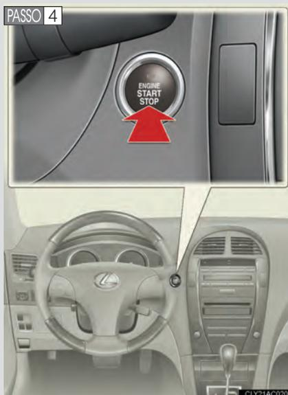
Pressione o interruptor do motor "ENGINE START STOP".
