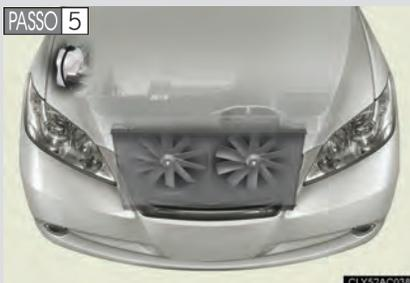
Após o motor esfriar suficientemente, verifique o nível do fluido de arrefecimento e inspecione o núcleo do radiador (radiador) quanto a vazamentos.
