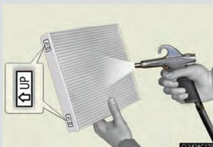
Para limpar o filtro, aplique ar comprimido, começando pela parte inferior.
