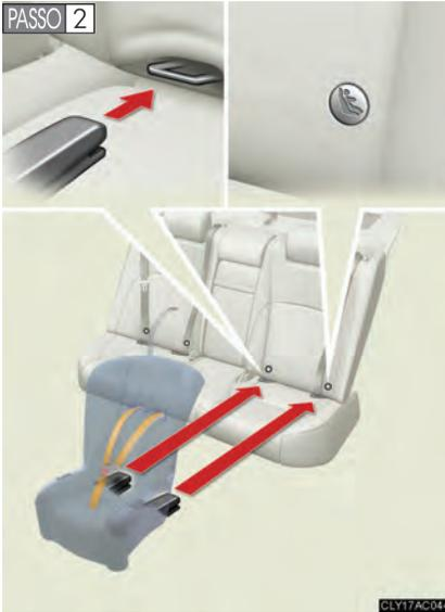
Encaixe as fivelas nas barras específicas de fixação.
