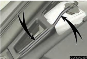
Ao instalar a tampa, certifique-se de que a mangueira do reservatório de fluido de arrefecimento do motor esteja posicionada conforme indicado na ilustração.
