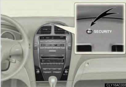
A luz indicadora pisca após o desligamento do interruptor do motor para indicar que o sistema está funcionando.
