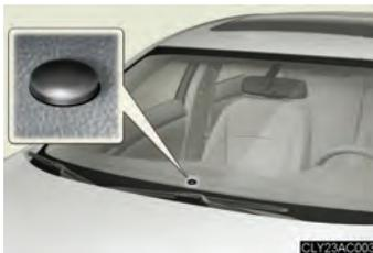
O sensor poderá não funcionar corretamente se um objeto for posicionado no sensor, ou se algum objeto estiver fixado no pára-brisa causando obstrução do sensor.
