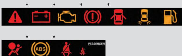
\*: Estas luzes irão acender quando o interruptor do motor for posicionado no modo IG-ON para indicar que a inspeção do sistema está sendo executada. As luzes irão apagar após a partida do motor, ou após alguns segundos. Poderá haver falha em um sistema se a luz não acender, ou se as luzes não apagarem. Providencie a inspeção do veículo em uma Concessionária Autorizada Toyota para veículos da marca Lexus.
