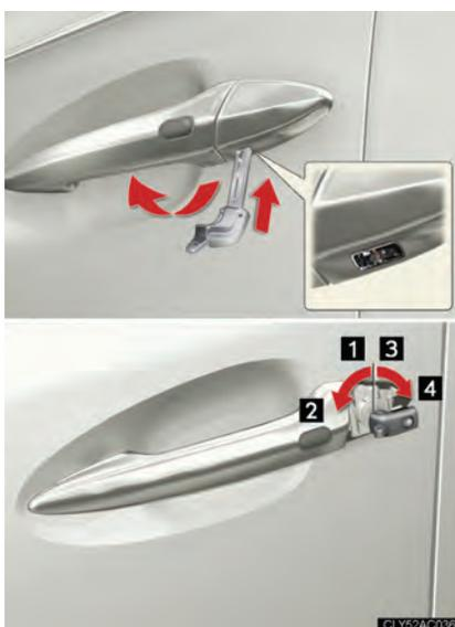
Remova a cobertura da maçaneta da porta do motorista usando a chave mecânica para executar as operações abaixo.
