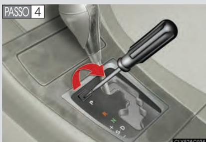
Alavanque a tampa usando uma chave de fenda ou equivalente.
