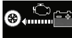
Quando o veículo for tracionado pelo motor a combustão e pelo motor elétrico (motor de tração)
