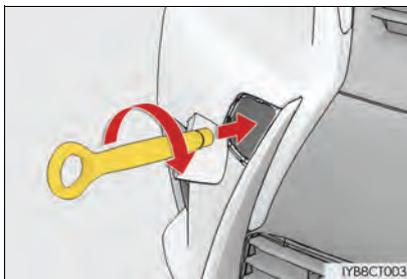
**4** Aperte firmemente o olhal de reboque usando uma chave de roda ou uma barra de metal rígida.
