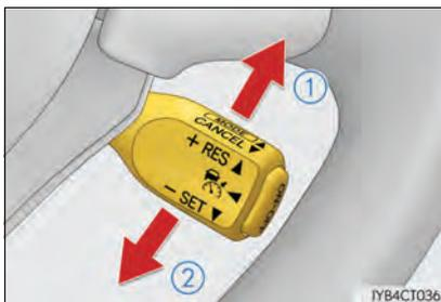
No modo de controle de distância de veículo para veículo, a velocidade ajustada será aumentada ou reduzida conforme segue:
