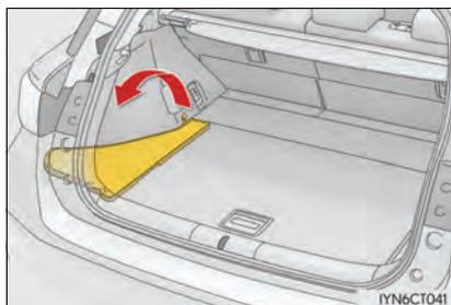
Levante a tampa esquerda do assoalho do compartimento de bagagem.
