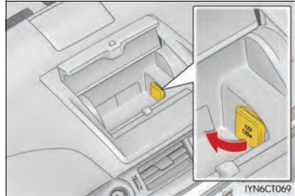
● A saída de energia pode ser usada quando o motor estiver no modo ACESSÓRIOS ou LIGADO
