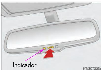
► Espelho retrovisor interno antiofuscante automático (tipo B)
