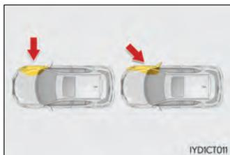
Os airbags laterais, em geral, não deflagram se o veículo for envolvido em uma colisão dianteira ou traseira, se capotar, ou ainda em caso de colisão lateral em baixa velocidade.
