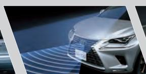
Assistente de pré-colisão com alerta sonoro e visual e frenagem automática (acima de 20 km/h)
